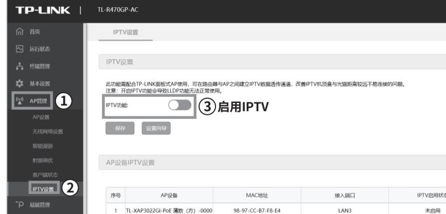
2 根据设备连接中的连接方式在对应软件界面中选择光猫连接方式和IPTV上联口,如下图所示:
