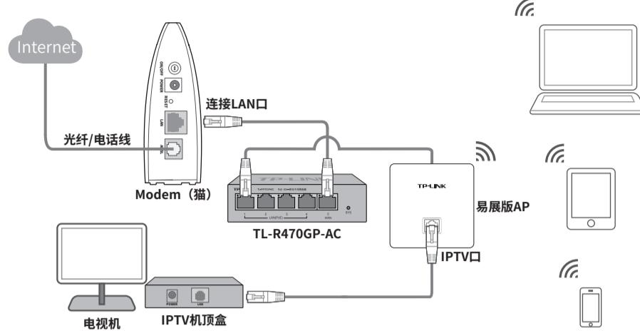
2 当光猫带IPTV口(上网和IPTV分线传输)时,请用网线连接光猫LAN口和主路由的WAN口,同时用网线连接光猫IPTV口和主路由的LAN口,如下图所示,其中主路由的LAN口需在软件配置过程中设置成IPTV口。
